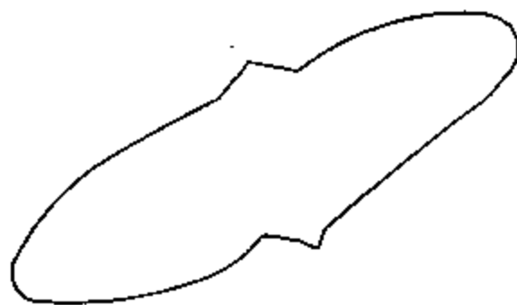
图 6-5 由输入噪声引起的 Lissajous 图形的畸变
